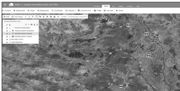
Slika 6. GIS Editor 193 HVZ-a s podlogom za prikaz vanjske hidrantske mreže na području Sinja. Izvor: vlastiti rad autora.
